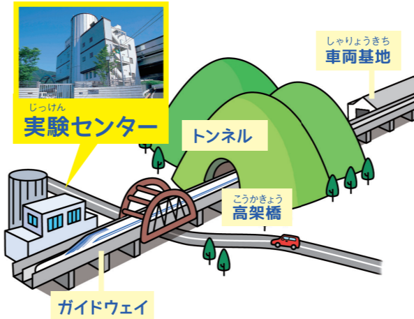
ガイドウェイ ルート概要図 実験線の総延長/42.8km (うちトンネル区間/35.1km)
